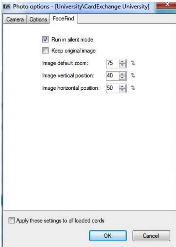
Verwenden Sie CardExchange® Professional or Ultimate edition dann haben Sie Zugriff auf die automatische Gesichtserkennung "FaceFind". Diese Funktion schneidet ein Foto auf das Gesicht zu, abhängig von der Analyse des Ausgangsfotos. In diesem Menü können Sie die Einstellungen für Größe und Seitenabstand festlegen.
