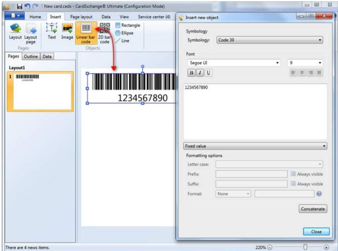
Um ein 1D Barcode Objekt einzufügen, wählen Sie **Linear Barcode** im Einfügen Tab und Klicken an die gewünschte Position. Anschließend wählen Sie die gewünschte Symbologie, sehr viele Arten werden unterstützt.
