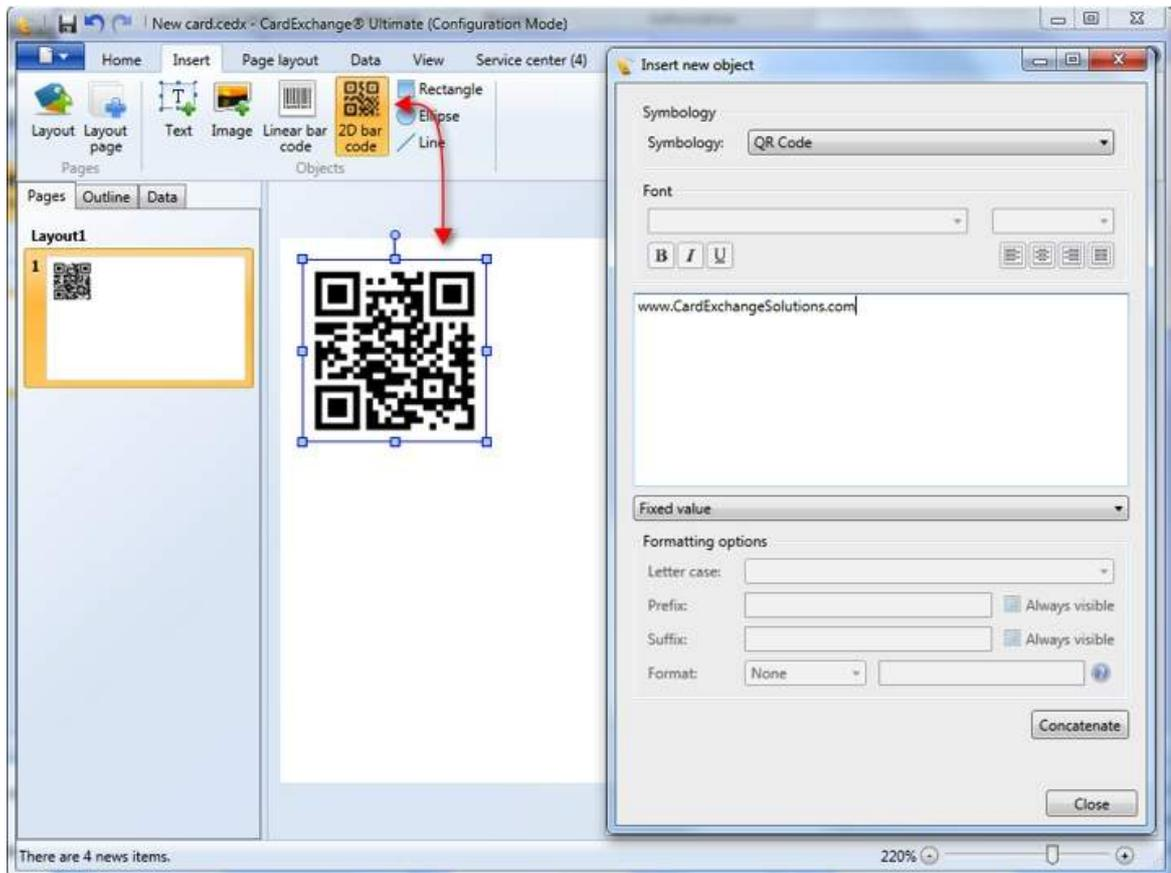
2D Barcodes können Sie im Einfügen Tab über den Button **2D barcode** einfügen, klicken Sie dazu auf die gewünschte Position. Anschließend wählen Sie die gewünschte Symbologie, sehr viele Arten werden unterstützt.
