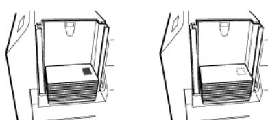
**4 安装送卡箱外盖，把送卡箱的旋钮设置在 [LOCK] 上**
