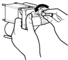
6 沿导轨插入盒子，直到听到“咔哒”一声，然后关闭打印机门
