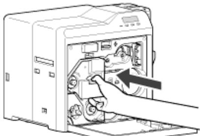
6 沿导轨插入色带盒，直到听到“咔哒”一声，然后关闭打印机门
