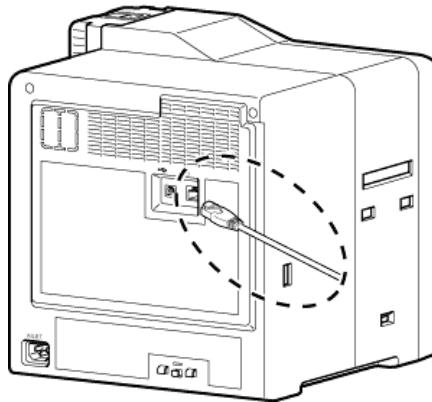
**3** 把 **LAN** 电缆插入安装在连接计算机网络上的集线器连接端
