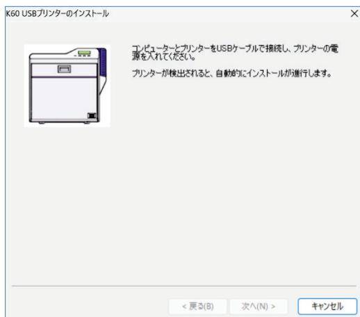
**12 プリンターとコンピューターをUSBケーブルで接続する****13 プリンターの電源を入れる**
