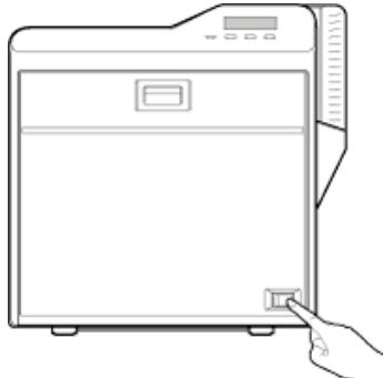
4 打印机的液晶面板上出现 [Ready]字样后, 开始打印
