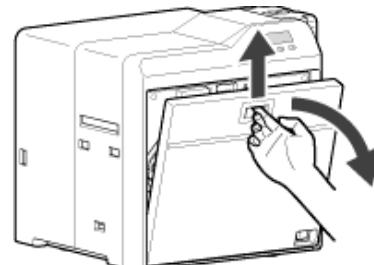
2 カセットボタンを押しながらインクリボンカセット（右側）を取り出す
