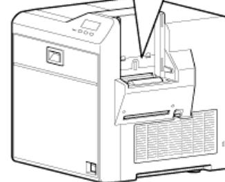
4 打开打印机门，并取下清洗组件
