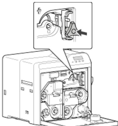
④ 在检查卡片位置时，顺时针转动清洗滚筒轴
