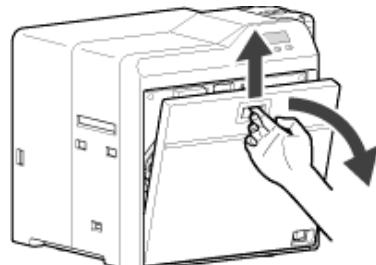
**2 按住盒子按钮，取下转印膜盒（在左边）**
