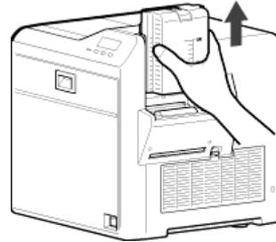
② 打开打印机门，检查卡片堵塞的位置
