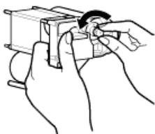
6 沿导轨插入盒子，直到听到“咔哒”一声，然后关闭打印机门
