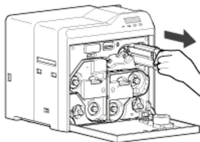
5 从卡片加载槽的卡片翻转组件中取出堵塞的卡片
