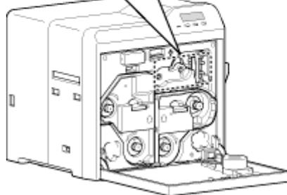
④ 在检查卡片位置时，顺时针转动送卡滚筒轴及清洗滚筒轴
