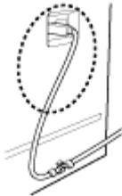
3 把 USB 电缆的另一端插入计算机的 USB 电缆连接端
